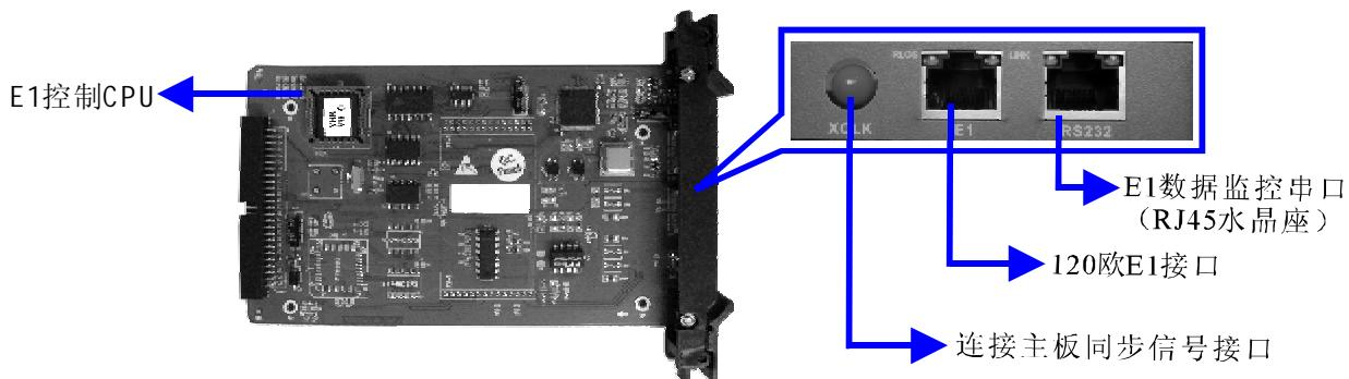
说明：A、E1接口：采用120欧RJ45接口，出厂时配有专用转换线（BNC接口）；左侧黄色指示灯为同步载波指示灯，常亮或闪烁代表状态异常，右侧绿色指示灯为链路指示灯，正常状态下为常亮，闪烁代表链路告警，不亮为异常；
