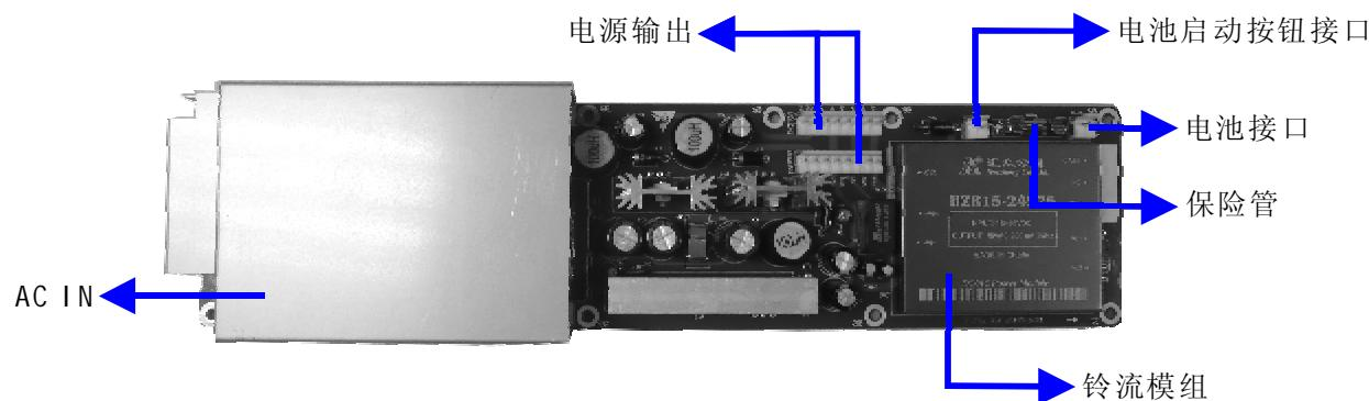
说明：NSN9000S/M-P01电源板由市电220/110VAC输入（正常使用状态下，严禁拨动220/110VAC切换开关），经电压转换电路转化为四组电压输出分别为：+30V、75VAC(RS)、-5V、+5V。电池充电采用250V/5A的保险管作为充电保护。
